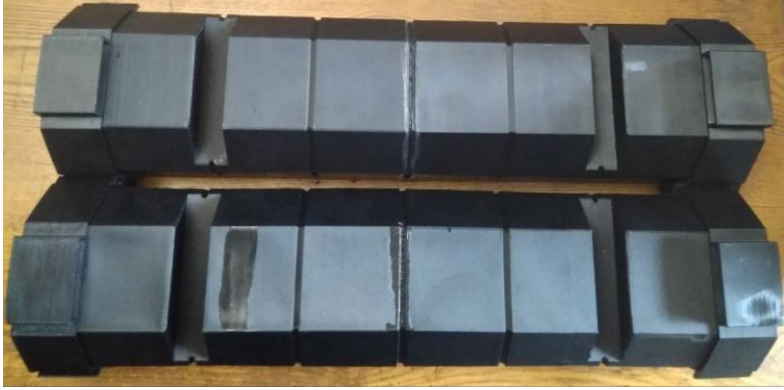
Рис. 2. Корпуси подовжених зарядів з PETG та TPE
