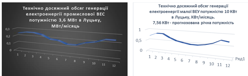
Рис. 1. Динаміка технічно досяжного обсягу генерації електроенергії у Луцьку при встановленні промислової ВЕУ потужністю 3,6 МВт та малої ВЕУ потужністю 10 КВт
