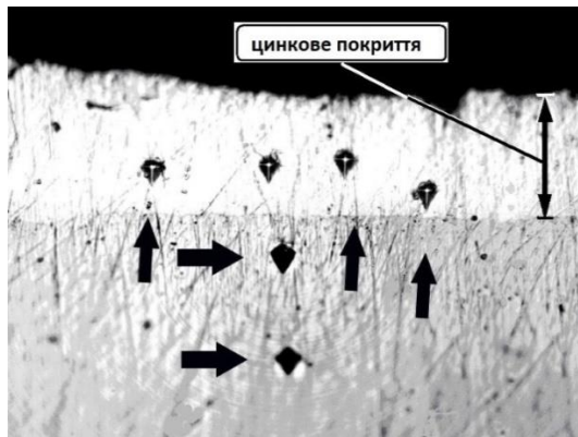
Рис. 1. Структура дифузійного цинкового покриття на зразку НКТ групи міцності Е після промислових випробувань у газодобувній свердловині газоконденсатного родовища, × 300
