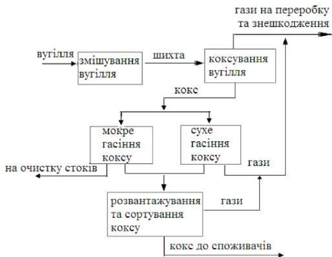
Рисунок 8.19 – Схема технологічного процесу виробництва коксу
