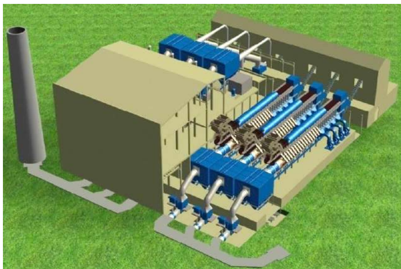
Рисунок 4.12 – 3D-модель модернізованої агломераційної машини № 7 в умовах ПрАТ «КАМЕТ-СТАЛЬ»
