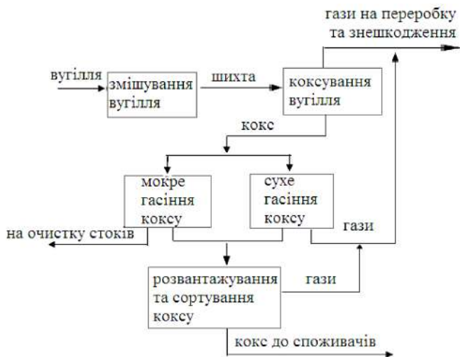
Рисунок 8.19 – Схема технологічного процесу виробництва коксу
