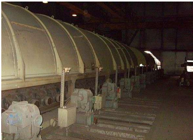
Рисунок 8.27 – Укриття хвостової частини агломашини на комбінаті «Запоріжсталь»
