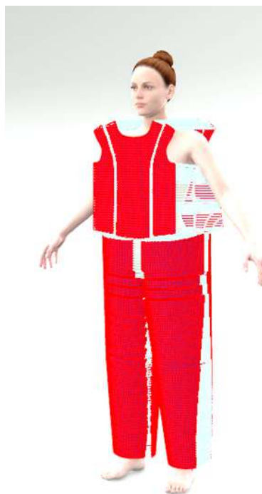
Рис. 3. Карта натягів/контакту на 3D-прототипі комбінезона у VStitcher.
