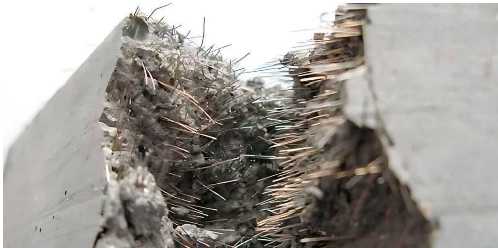
Рис. 2 – Зовнішній вигляд сталевібробетону / структура сталевібробетону зі сталевібробетоном
