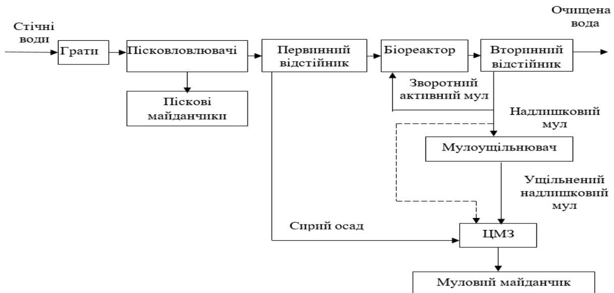
Рис. 1 –Типова принципова технологічна схема очищення стічних вод
