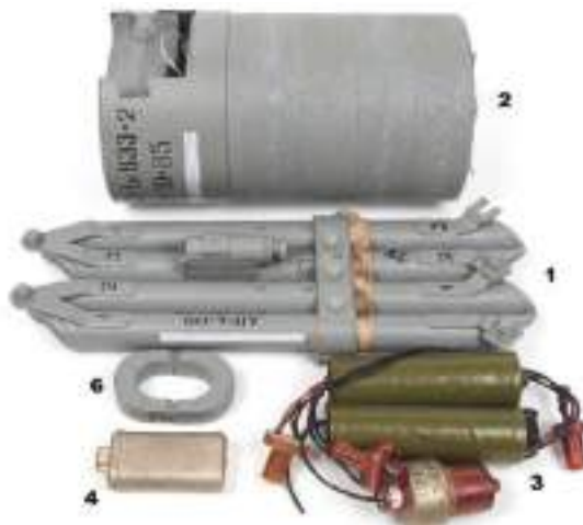
Рисунок 106. Вибухозапалювальний заряд ВЗЗ-2 1 – підрильний заряд ПЗ-1; 2 – запалювальний заряд ЗЗ-1 з поплавцем; 3 – підрильний пристрій ВУЗ-2; 4 – підривач сповільненої дії ВЗД-3М/ВЗД-6ч (не остаточно споряджений); 6 – магніти
