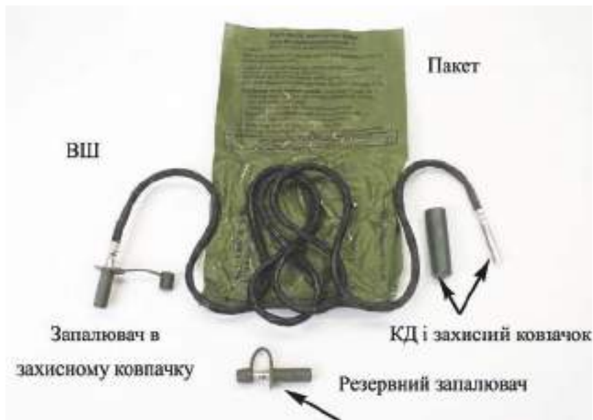
Рисунок 252. КД т/46 з ВШ і запалювачем (ЗТП)
