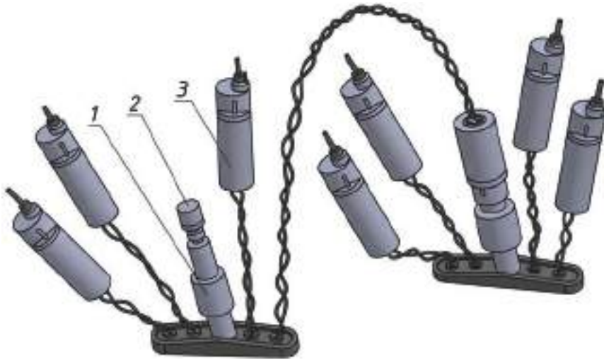
Рисунок 187. З'єднання двох ВУЗ-4 в каскад 1 – генератор з основою; 2 – підривач ВЗД-3М; 3 – накольний пристрій
