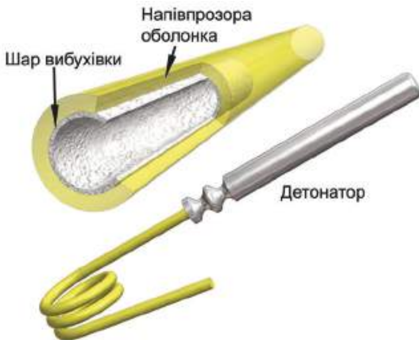
Рисунок 207. Modernized Demolition Initiators, MDI
