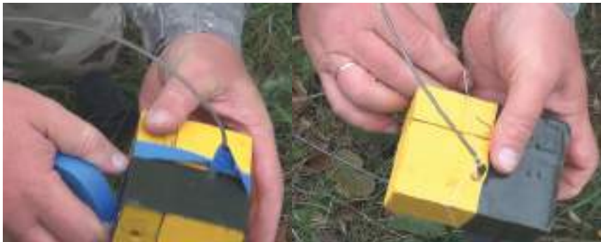
б) за допомогою ізолювальної стрічки в) за допомогою гумки з комплекту дето- натору М19
