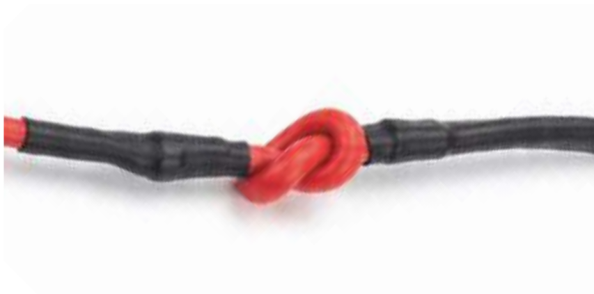
Рисунок 262. Зрошування ДШ RIOCORD PV 10 C-250 вузлом «подвійна петля»
