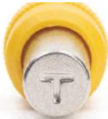
Рисунок 232. Маркування на ЕД DM42A1
