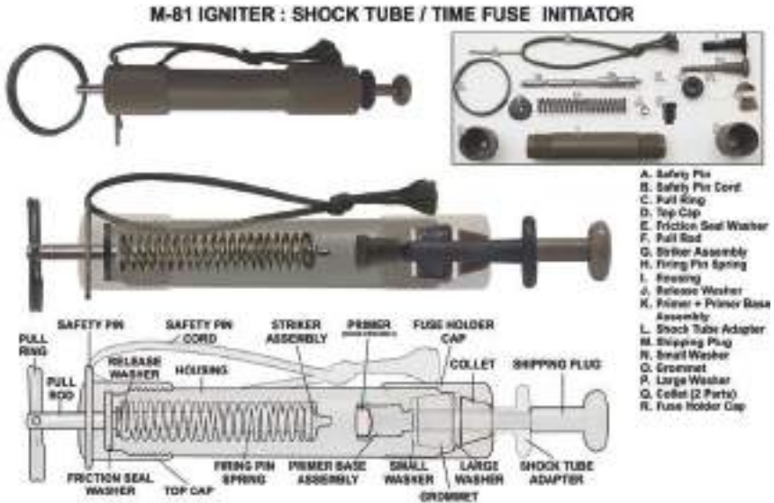
Рисунок 210. Устрій запалювача M81
