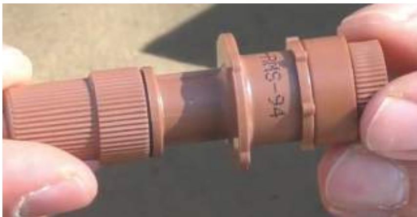
Рисунок 241. Запалювач ВШ AL MLEN F1
