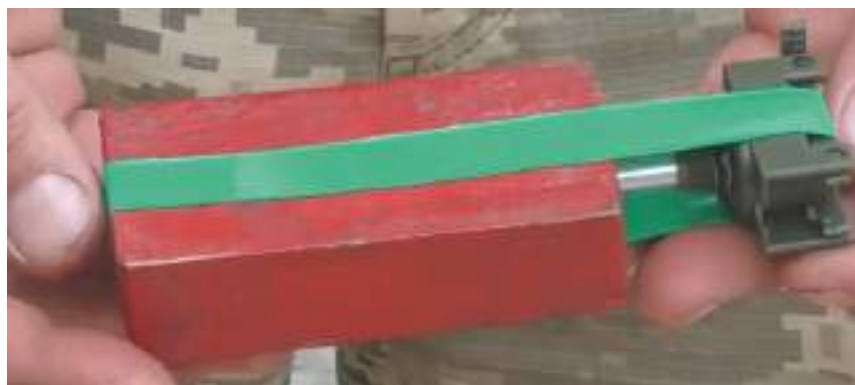
Рисунок 245. Застосування вузла передачі детонації КД АМ CORD F1 з тротиловою шашкою радянського зразка
