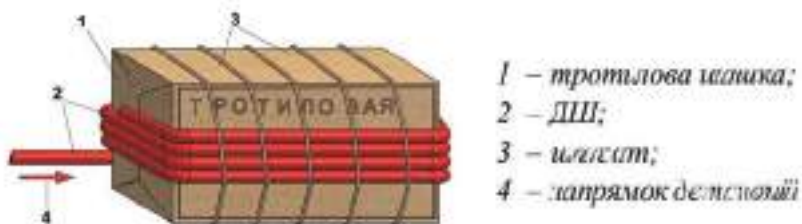
Рисунок 158. Тротилова шашка, підготовлена до безкапсульного підривання ДШ «бойовик»
