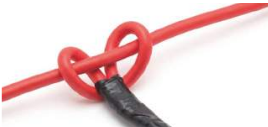
Рисунок 263. Зрошування ДШ RIOCORD PV 10 C-250 прямим вузлом
